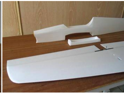
Le fuselage vient d'être découpé pour recevoir l'aile.
