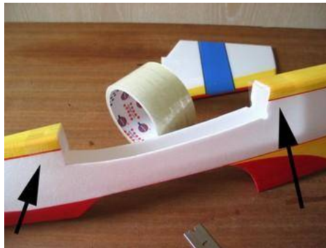
Du scotch transparent évite d'arracher le Dépron en démontant l'aile qui est simplement scotchée.
