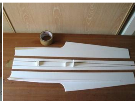
Les flancs avant collage, en utilisant les dépoilles du fond en Dépron de 3 mm comme guides.
