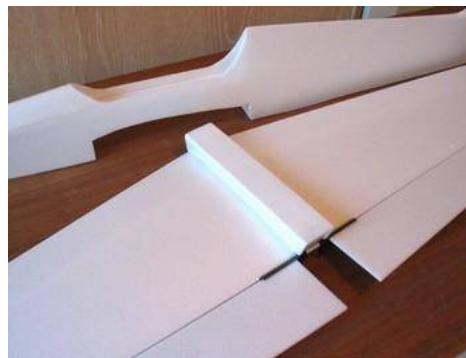
Le dessous de l'aile reçoit le fond du fuselage.
