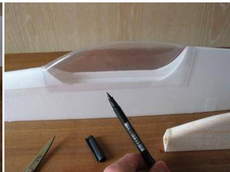
La verrière nécessite une découpe précise avec un recouvrement de 4 mm environ marqué au feutre.
