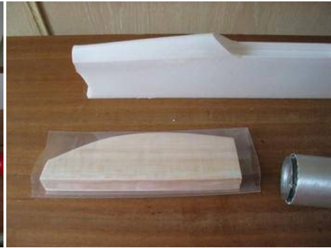
La gaine est glissée sur la forme en balsa. Couleur au choix...
