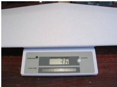
L'aile sans les ailerons pèse 36 g.
