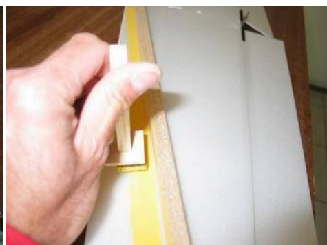
La peinture est appliquée au tampon en suivant une règle.
