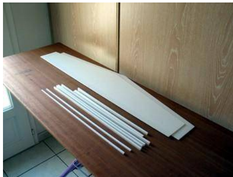
Les éléments nécessaires à la réalisation de l'aile : rien que du Dépron.
