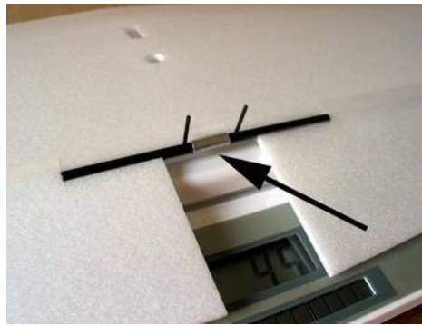
Le tube alu guide les commandes d'ailerons.
