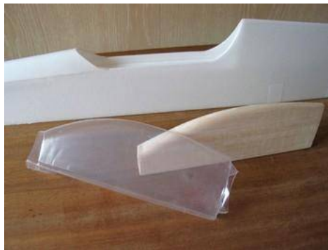
La verrière vient juste d'être thermoformée. Attention les doigts.
