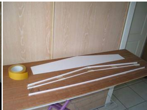
Le bati de montage de l'aile en Dépron de 6 mm évite tout vrillage, la fixation provisoire se fait au scotch double face sur le chantier.
