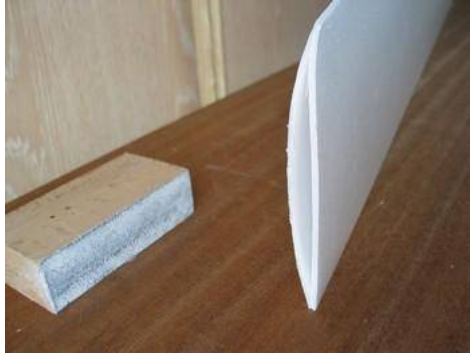
Côté saumon, on voit bien que l'aile est creuse.
