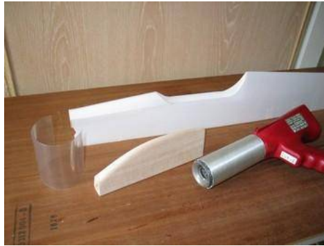
Pour réaliser la verrière, il vous faut un décapeur thermique, de la gaine et la forme en balsa.
