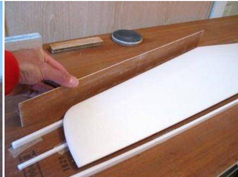
Les bords sont ponçés finement avec une cale de grande longueur.
