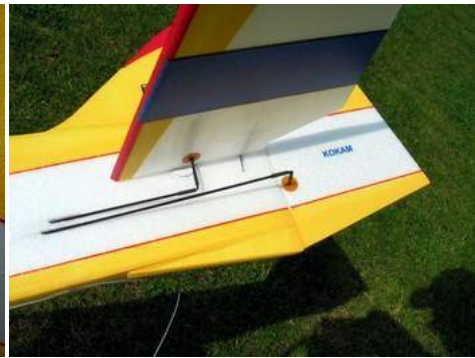
Les commandes sortent à gauche sous le stabilisateur
