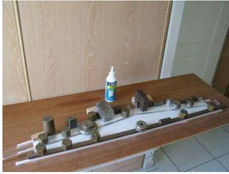
L'aile est mise sous presse pendant le durcissement de la colle blanche.
