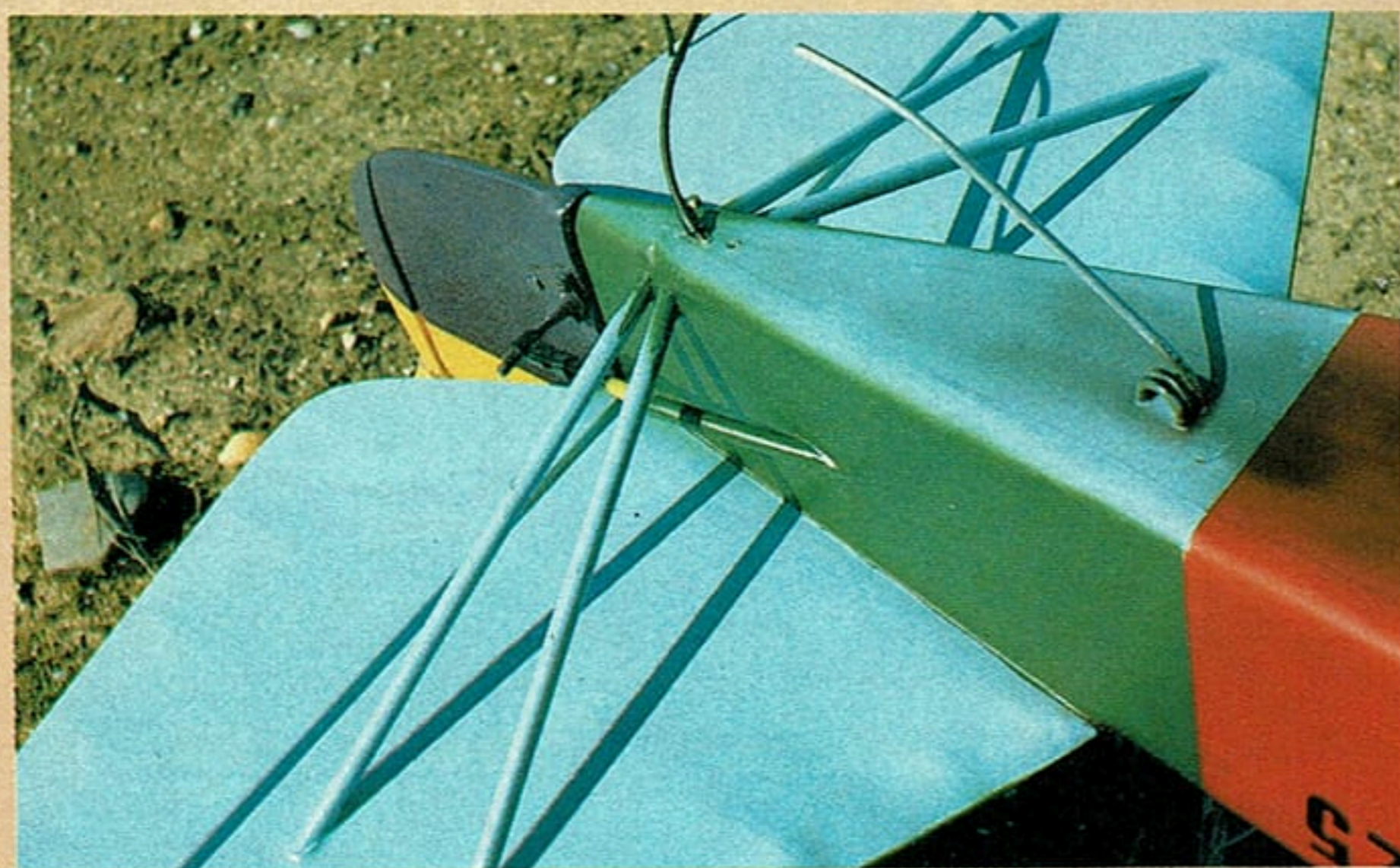
El cable de antena se ha ocultado en el interior del fuselaje, saliendo por la parte inferior de la cola.
