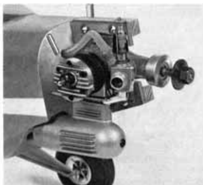
Abb. 9 Der angebaute Glühkerzenmotor OS MAX III 15. Deutlich ist die Führung des Entlüftungs- und Füllschlauches zu sehen.
