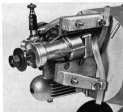
Abb. 9 Der angebaute Glühkerzenmotor OS MAX III 15. Deutlich ist die Führung des Entlüftungs- und Füllschlauches zu sehen.
