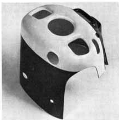
Abb. 8 Die ausgesparte Motorhaube für den OS MAX III 15
