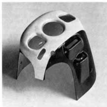
Abb. 8 Die ausgesparte Motorhaube für den OS MAX III 15
