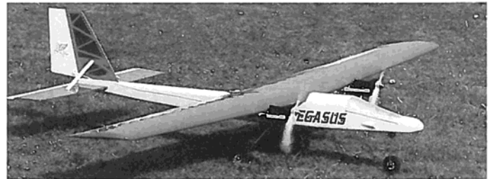
Der Pegasus ist bodenstartfähig; je besser die Piste, desto kürzer die Startstrecke und desto mehr „Saft“ bleibt zum eigentlichen Fliegen
