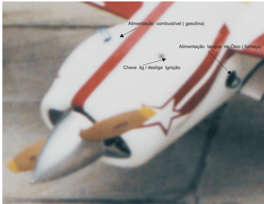
Carenagem de fibra de vidro, Helice 26X10 Menz, Spinner de aluminio Tru Turn de 5 polegadas
