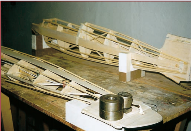
Nelle foto di questa pagina, le fasi salienti della costruzione del "Senior Professor". L'ala e i piani di coda non presentano particolari difficoltà, mentre la fusoliera viene montata per metà sul piano e per il resto "in aria". Pur non trattandosi di un modello da principianti, è comunque alla portata di chi abbia un minimo di esperienza costruttiva. Le foto saranno comunque un ottimo aiuto per tutti.
