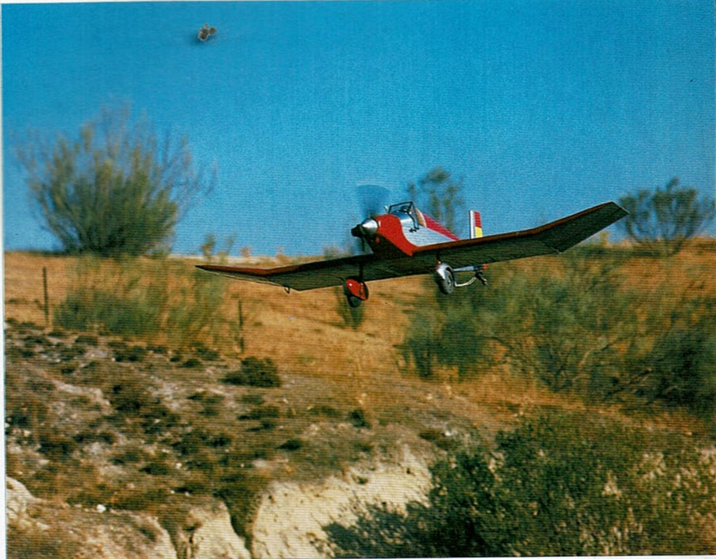
En vuelo fue preciso reducir el gas, hasta dejarlo en un ralentí alto, para que la velocidad de vuelo fuera acorde con el tipo de avión reproducido.
