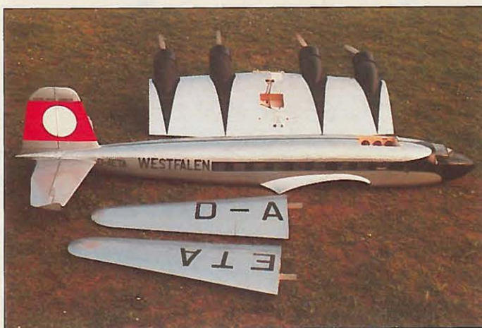
Zerlegt zum Transport. Die obere Rumpfföffnung dient der „Betankung“: Dort werden 36 Akkuzellen eingeschoben
