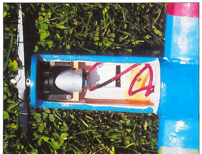
Im Rumpf, leicht zugänglich, der Akku. In den Gondeln, ebenso leicht zugänglich, die „Speed 400“ mit Getriebe
