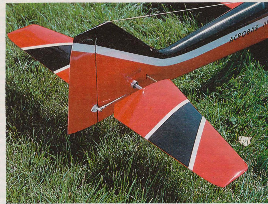
Empenaje trasero. Para mayor detalle el plano derecho del estabilizador todo móvil se muestra semidesmontado.
