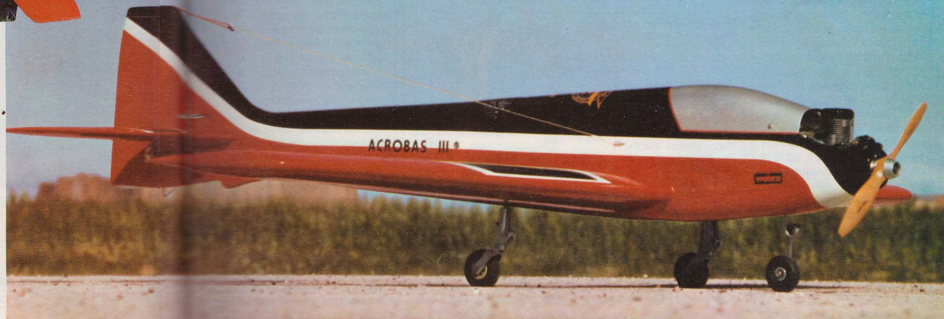
En la imagen la estilizada línea del Acrobacias III. Para volar, el espiner de la hélice se sustituye por un cono de aluminio perfectamente mecanizado, con objeto de reducir las vibraciones al mínimo. El tren de aterrizaje principal es del tipo de suspensión con muelles.
