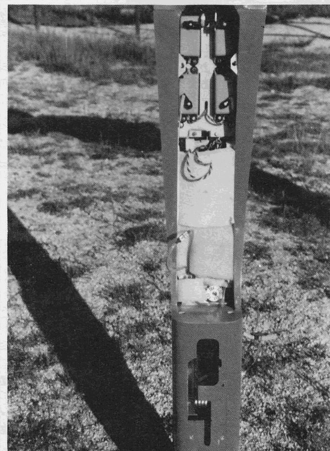
Compartimento del fuselaje con detalle de la instalación del equipo de radio. El servo del fondo, próximo a la segunda cuaderna corresponde al mando del tren de aterrizaje.
