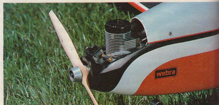
Unidad motriz. En la foto, la boca de entrada de aire para refrigeración del sistema de escape.
