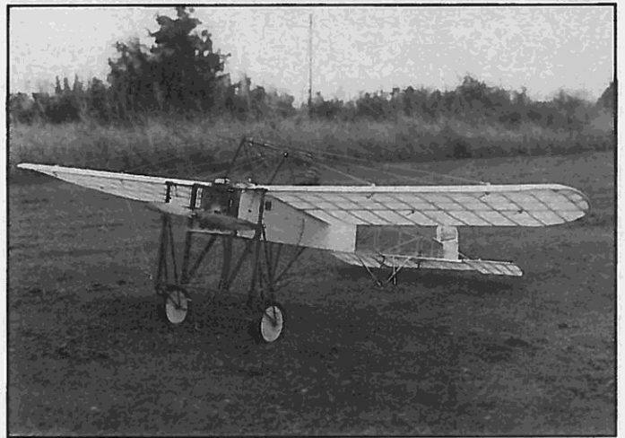
Von der Rumpfunterseite sichtbar die Flügelverwindungsmechanik
