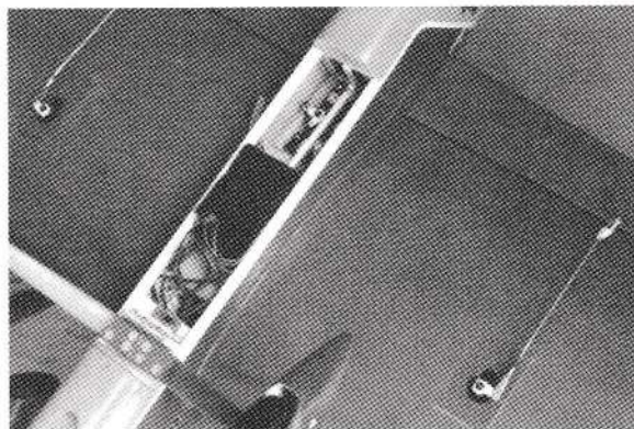
I due microservi degli alettoni. Per la loro miscelazione con il timone di profondità, è indispensabile usare una radio dell'ultima generazione.
