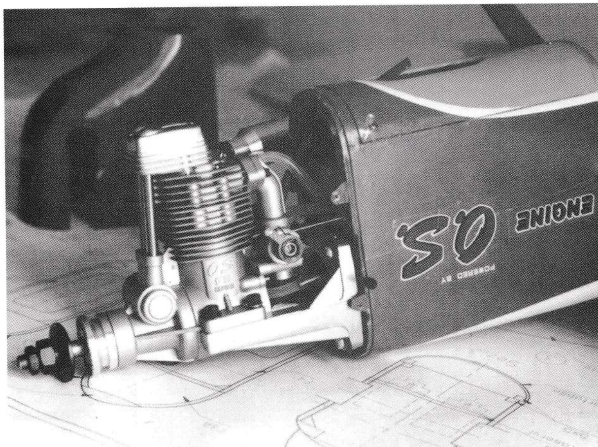
Il bellissimo OS quattro tempi da 12cc si inserisce perfettamente nel vano motore ed il silenziatore di serie non disturba la linea del modello. Il musetto è realizzato con la tecnica descritta a pagina 14 del n°1 di MODELLISMO.
